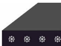
řez dopravním pásem s ocelolanovou kostrou
