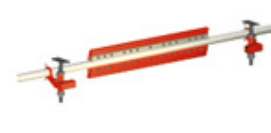
před-stěrač typ B9S šířka pásu 1000 - 3200mm rychlost pásu až 4.5 m/s
